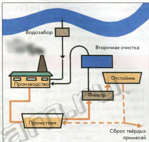
Рис. 148. Схема водооборотного цикла
